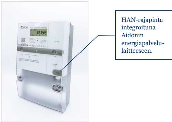
Kuva 1: Integroitu HAN- rajapinta Aidonin energiapalvelulaitteessa.
